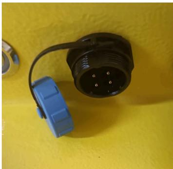
4. Закрепите внешний индикатор в удобном для оператора техники месте и проведите кабель индикатора в аккумуляторный отсек техники. При необходимости закрепите кабель внешнего кабельными стяжками к технике. Убедитесь, что кабель индикатора надежно зафиксирован и исключена возможность его повреждения
