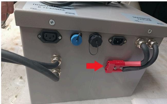
5. Подключите сетевой кабель зарядного устройства (220В) к розетке на корпусе АКБ
